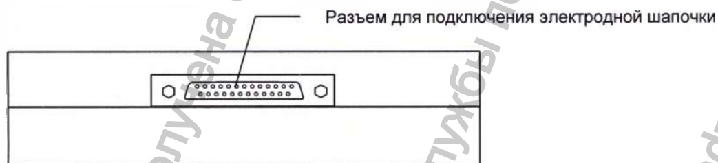
Рис. 4. Внешний вид нижней торцевой панели блока усилителей
