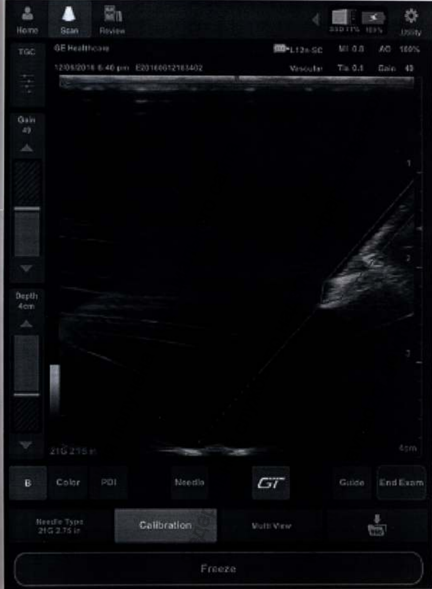
22. Модуль программный для обучающего набора Piproint GT – виртуальное отслеживание иглы, активируемый электронным ключом
