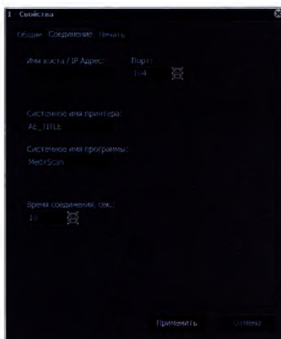
Рисунок 8.16 – Настройка соединения с DICOM принтером
