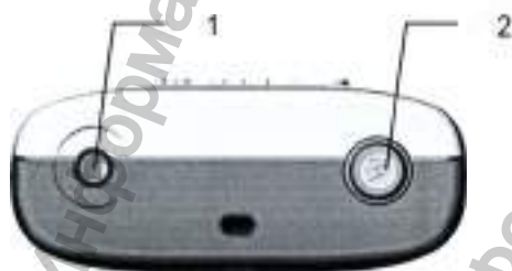
Рис. 12. Верхняя торцевая панель блока для импедансометрии системы «Аудио-СМАРТ».
